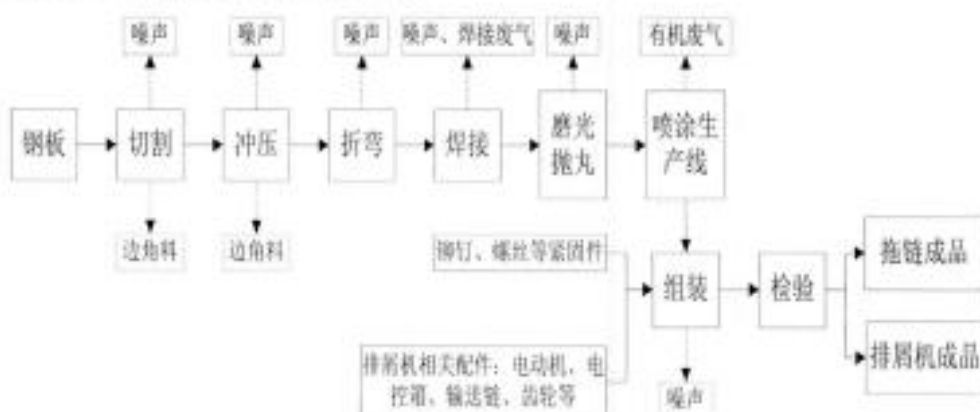
图 1 拖链、排屑机生产工艺及产污环节流程图
