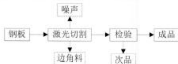
图 3 激光切割加工工艺流程及产污环节图
