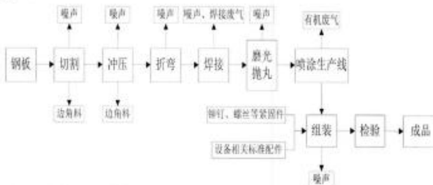
图5 绿色智能化设备生产工艺流程及产污环节图
